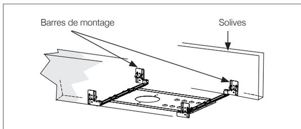
3. Pour raccourcir les barres de montage à 10 po (254 mm), retirer et couper à la marque (voir vue de détail des barres de montage ajustables).
