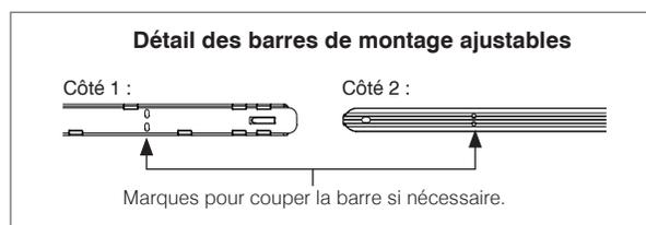
4. Une fois la longueur des barres de montage établie, écraser les languettes pour bloquer les barres de montage sur la plaque. À l'aide d'une pince, serrer les crochets en U sur les profilés en T (si applicable).
