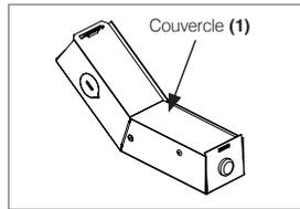
6. Insérer la boîte de jonction sur la plaque de montage nouvelle construction en utilisant l'étiquette située sur le dessus de la boîte de jonction comme guide afin d'aligner le support de fixation au bon endroit.
