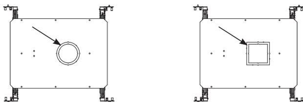
2. Localiser le positionnement de la plaque de montage et la fixer sur les solives (ou les profilés en T) avec les barres de montage ajustables (10 po (254 mm) à 24,5 po (622 mm)).
