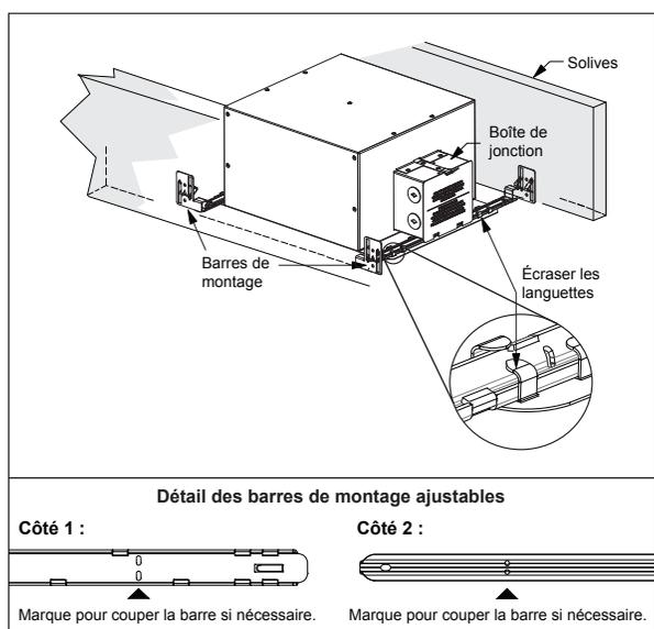
4. Amener le filage électrique jusqu'au boîtier, en conformité avec les codes électriques en vigueur dans votre région.
