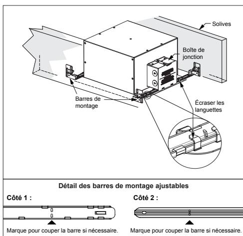
5. Amener le filage électrique jusqu'au boîtier, en conformité avec les codes électriques en vigueur dans votre région.
