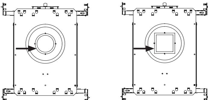
3. Avant d'installer le recouvrement de plafond, localiser le positionnement du cadre de montage et le fixer sur les solives avec les barres de montage ajustables de 10 po (254 mm) à 24,5 po (622 mm). Pour raccourcir les barres de montage à 10 po (254 mm), retirer et couper à la marque (voir vue de détail des barres de montage ajustables).
