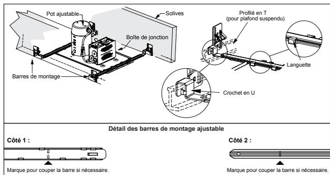
4. Amener le filage électrique jusqu'au boîtier, en conformité avec les codes électriques en vigueur dans votre région. Ouvrir la boîte de jonction et faire le branchement des fils conformément aux diagrammes ci-dessous. Fermer la boîte de jonction en replaçant le couvercle.
