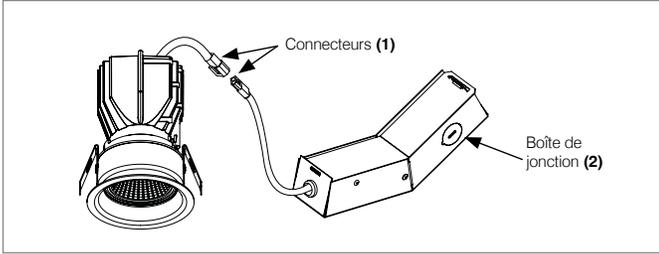
8. Insérer la boîte de jonction (2) dans le trou de perçage et la déposer sur le plafond ou sur la plaque de montage pour nouvelle construction (en option).
